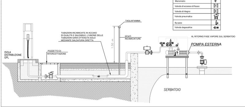
**SEZIONE TIPICA DI INTERRAMENTO DELLE TUBAZIONI GPL**
