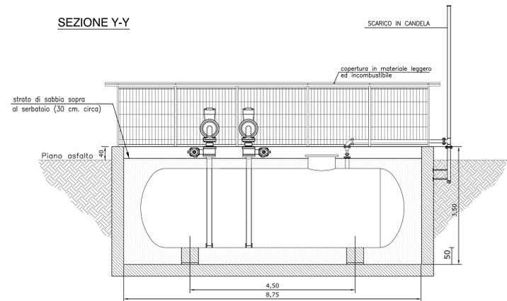
**PARTICOLARE DELLA CASSAFORMA PER SERBATOIO GPL capacità 30 mc**
