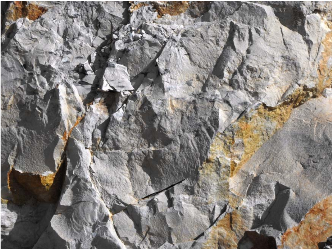
Foto 3.1-3.2 - In cava sono presenti rocce calcareo-dolomitiche di colore bianco-grigiastro, a frattura scheggiata, in strati medi e spessi, con locali intercalazioni di calcari dolomitici di colore grigio scuro (“Calcare di Altamura”).
