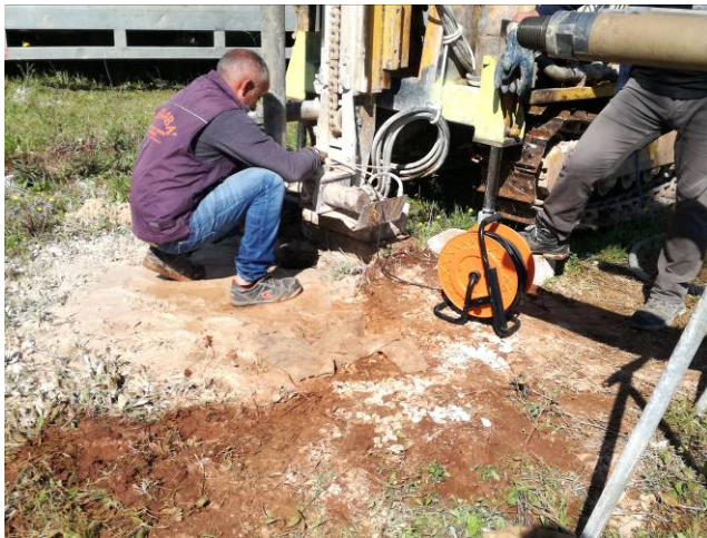
Foto 8.1÷8.4 - Esecuzione delle prove di permeabilità Lefranc nei fori di sondaggio.
