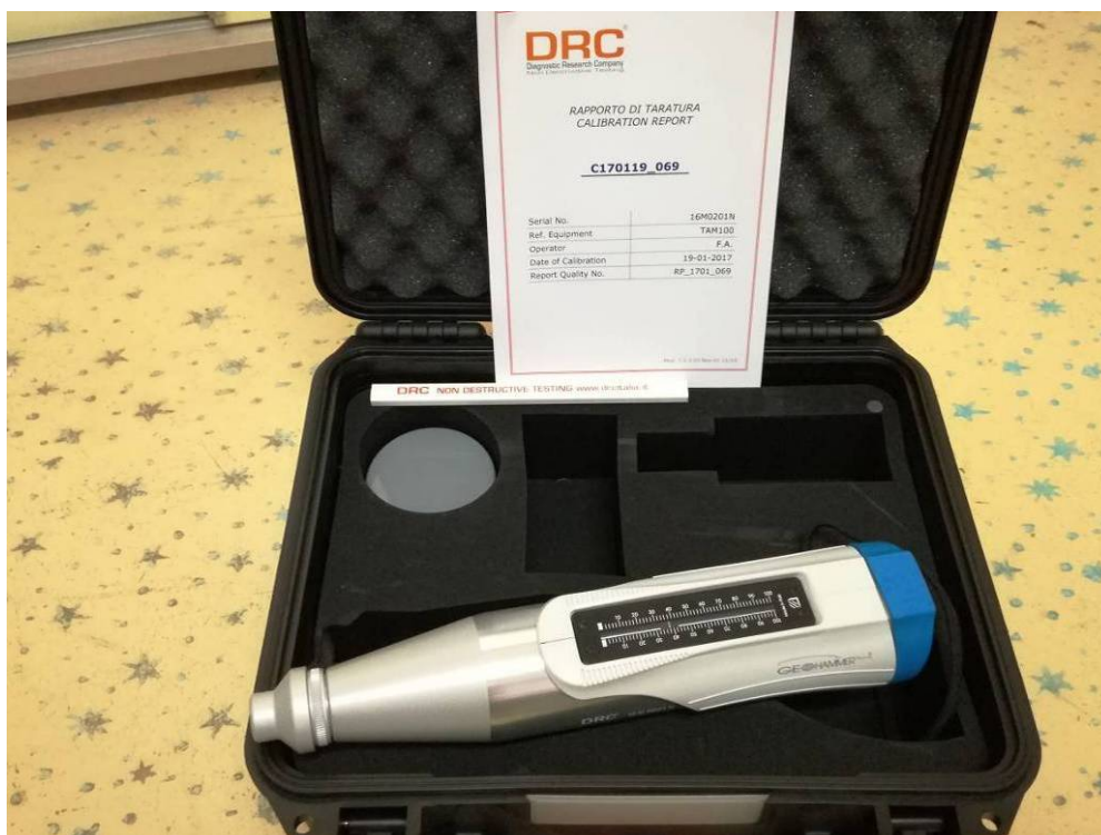
Foto 6.5 – Il GeoHammer utilizzato per le misure di durezza superficiale.
