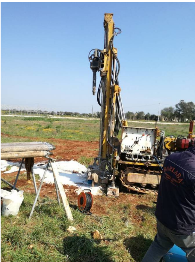
Foto 5.1÷5.6 - Fasi di esecuzione dei sondaggi geognostici a carotaggio continuo.
