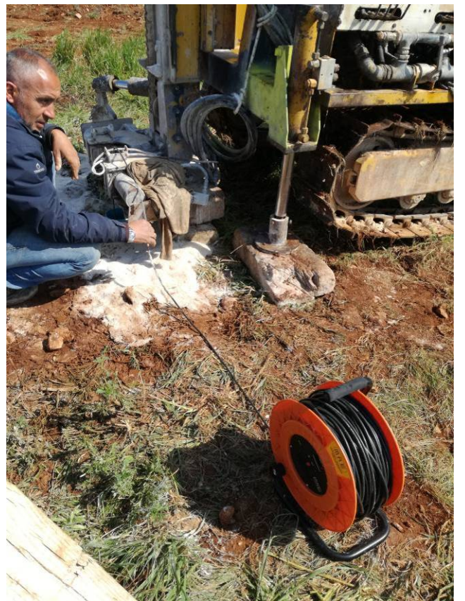
Foto 8.1÷8.4 - Esecuzione delle prove di permeabilità Lefranc nei fori di sondaggio.
