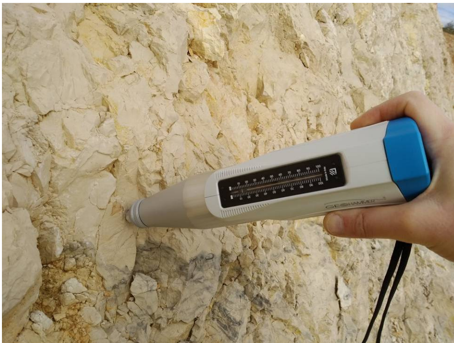
Foto 6.6 – Esecuzione delle misure con il GeoHammer sulla parete nord di cava.
