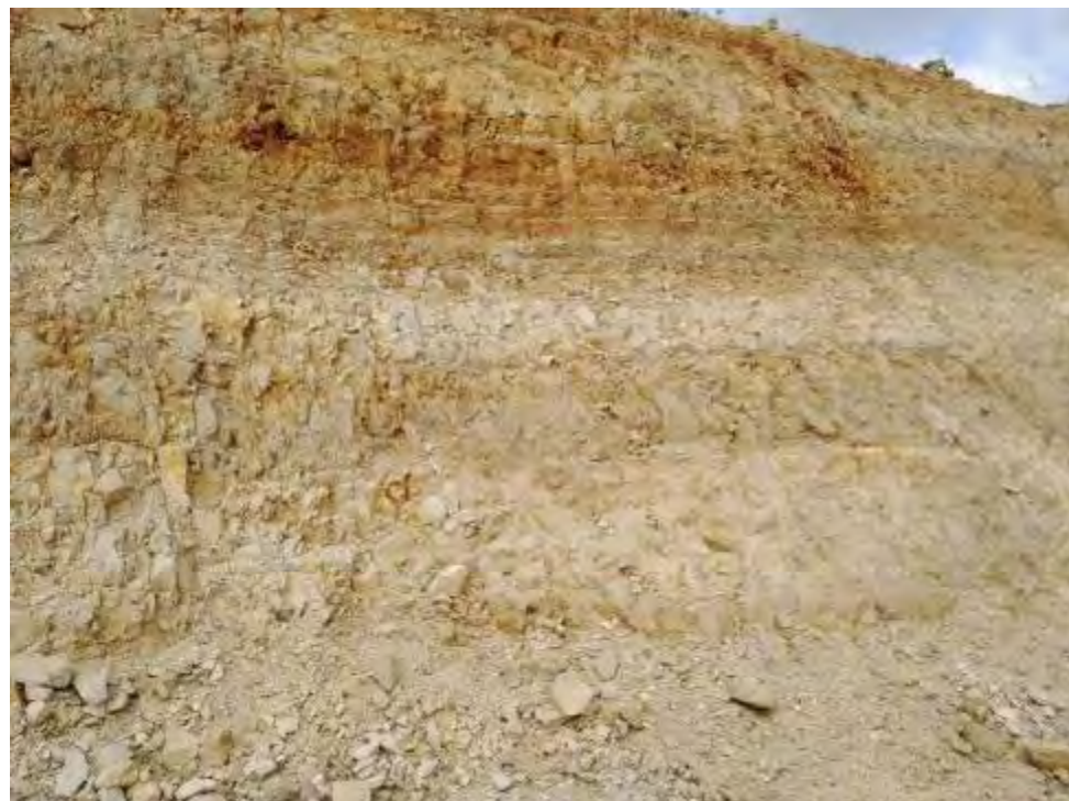
Foto 3.19 - Si nota come la giacitura degli strati sia “sub-orizzontale”, quindi non a “franapoggio” (potenzialmente in grado di generare frane per scivolamento), il che significa che l’assetto giaciturale della roccia calcarea lungo le pareti della cava contribuisce, di per sé, a generare condizioni di stabilità. Non si individuano famiglie di giunti di fratturazione a grande scala (metri o decine di metri) che possano isolare porzioni di roccia o cunei instabili o prossimi al crollo. Sono presenti unicamente fessure a piccola scala (decine di cm) che, al limite possono provocare il distacco di frammenti di roccia di dimensioni decimetriche o pluri-decimetriche.
