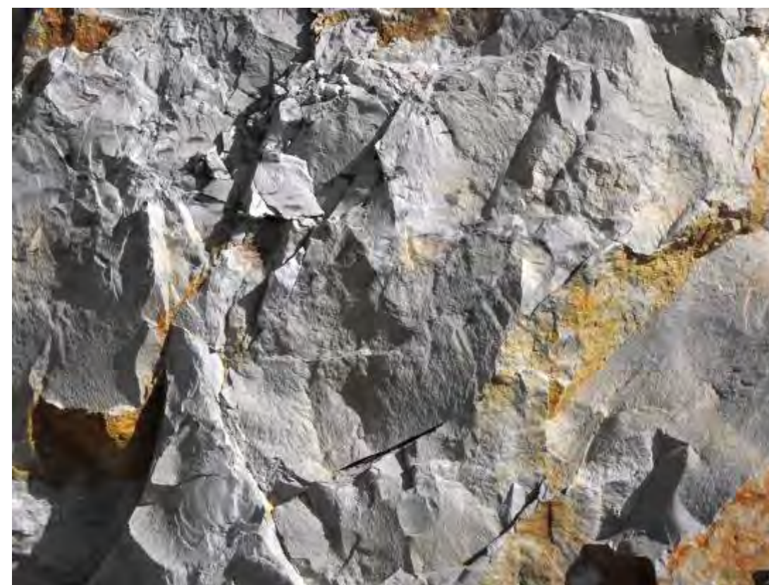
Foto 3.6-3.7 In cava sono presenti rocce calcareo-dolomitiche di colore bianco-grigiastro, a frattura scheggiata, in strati medi e spessi, con locali intercalazioni di calcari dolomitici di colore grigio scuro ("Calcare di Altamura").
