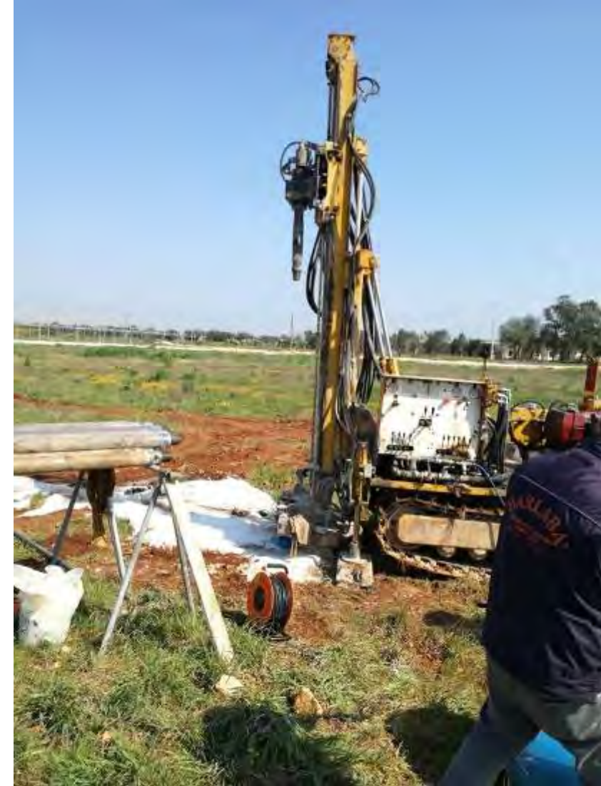
Foto 3.11÷3.16 - Fasi di esecuzione dei sondaggi geognostici a carotaggio continuo.
