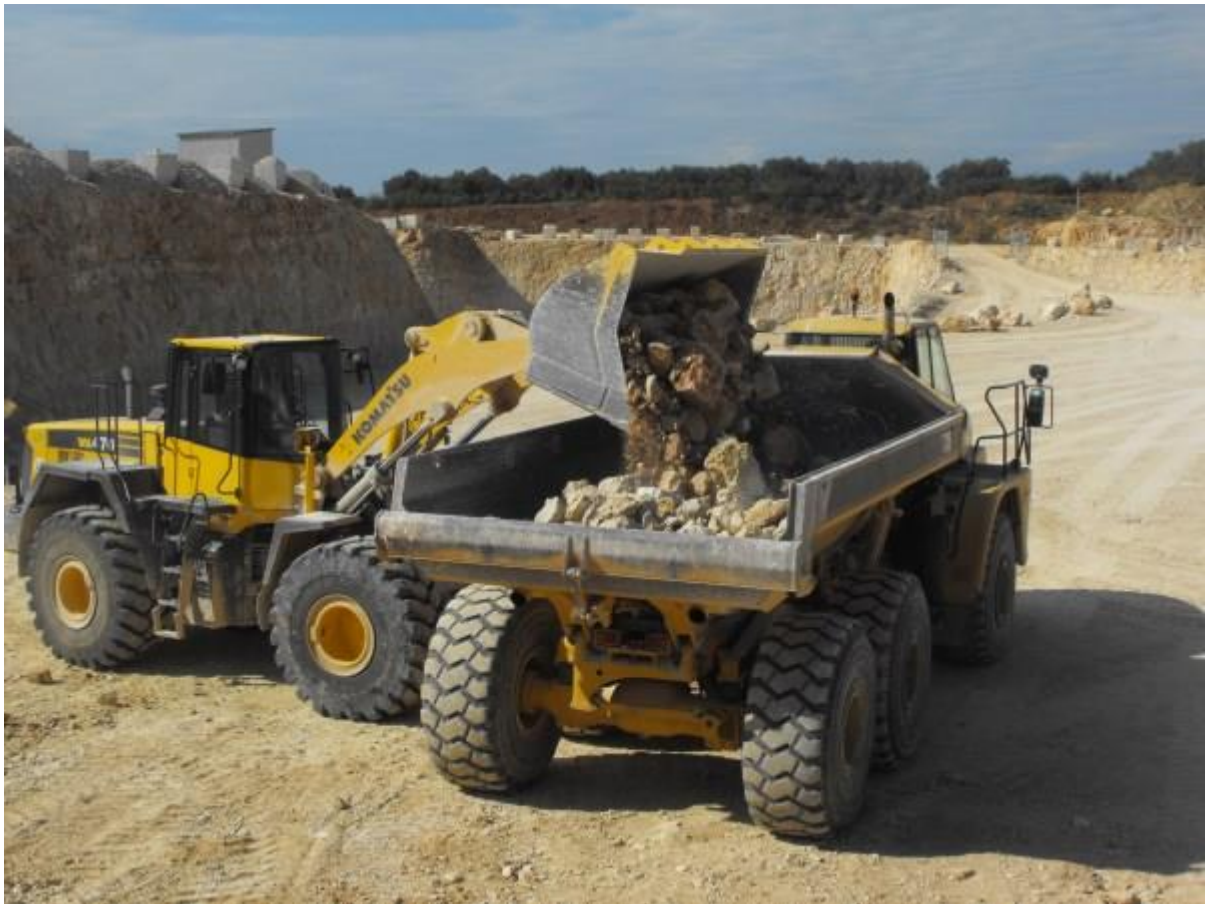
Foto 22 – Una pala meccanica provvede a caricare il materiale estratto su camion a cassone ribaltabile
