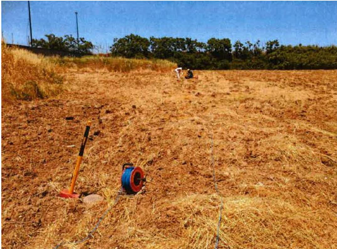
**Fig. 24** – Indagine sismica M.A.S.W.
