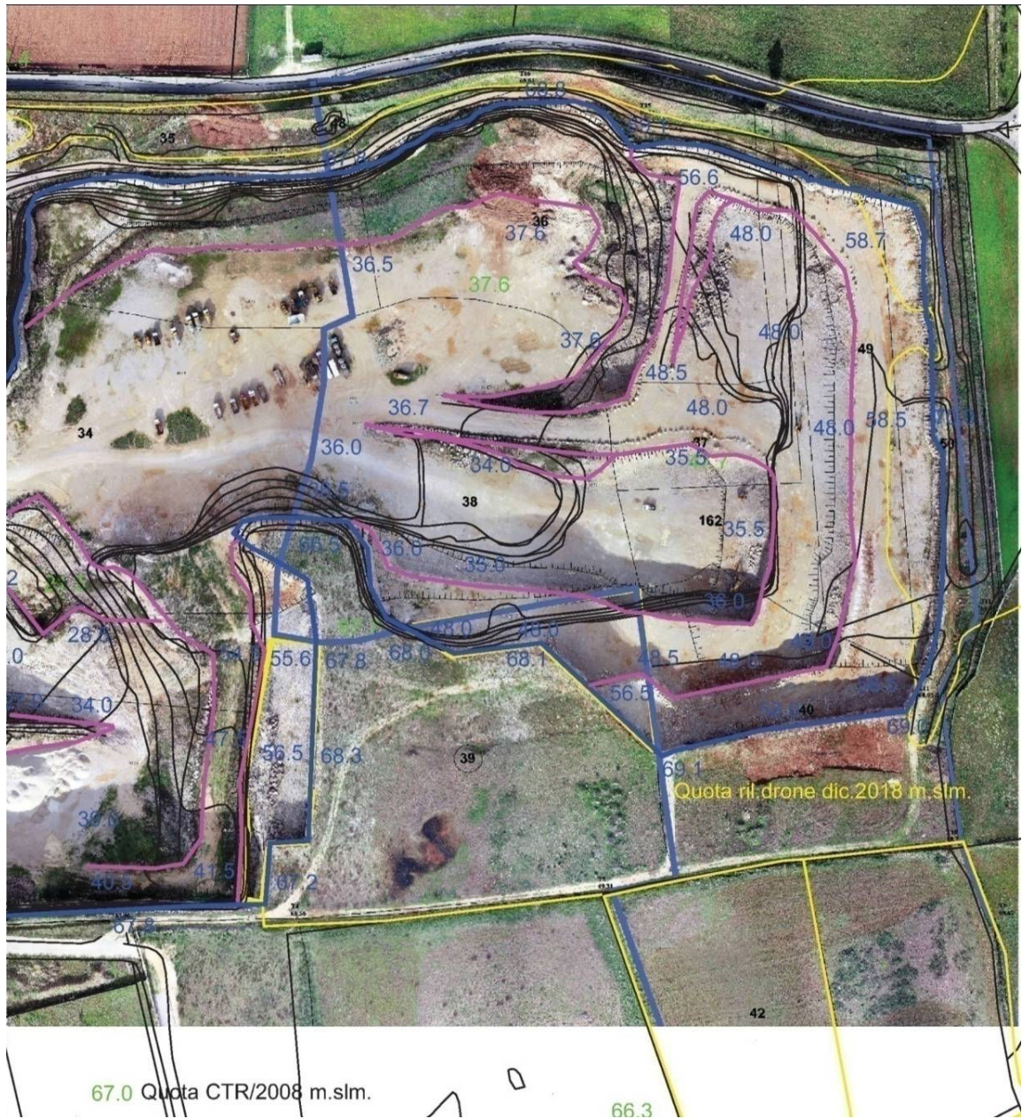
Fig.5 - Ortofoto di rilievo su CTR/2008 con quote semplificate rilevate dal drone
