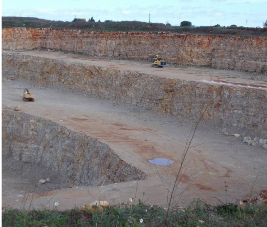
Foto 5 - Perimetro di scavo Est a fronte multiplo
